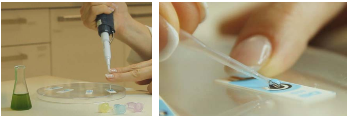
Figura 2. Procedure di immobilizzazione dei biomediatori su elettrodi printati.
